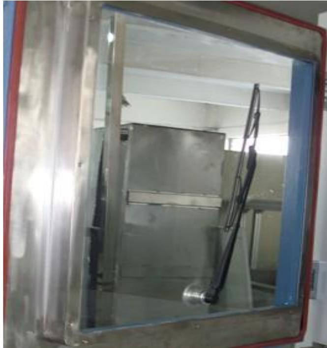
5、试验箱外壁材料为冷轧钢板防锈处理后喷涂，内壁采用 SUS304 不锈钢板加工成型，机架为槽钢防锈处理后喷涂。
